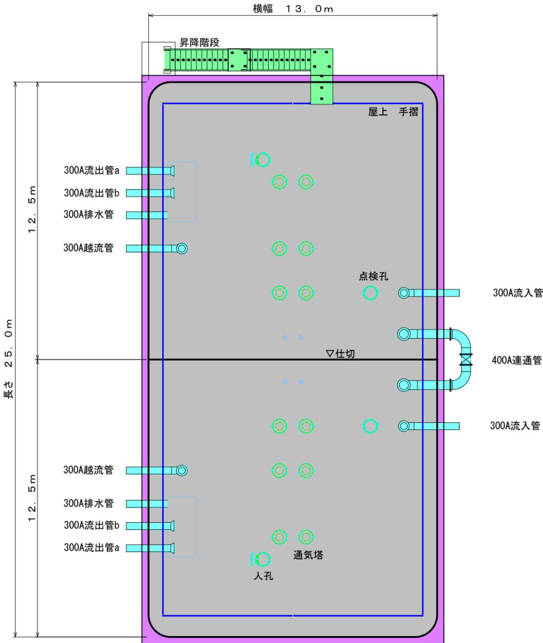
中継槽 一般構造図 S=1:100
